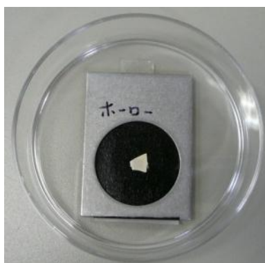
図 4 ホウロウ製鍋の釉薬を剥離したサンプル（写真）
